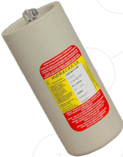
Die Dämpfer zeichnen sich durch einen großen Medieneinlass aus, so dass auch viskose Stoffe wirkungsvoll gedämpft werden können. Die als Blasen Speicher ausgeführten Dämpfer werden mit einem Vordruck mittels Druckluft vorgespannt. Dieser Vordruck muss in Abhängigkeit vom Betriebsdruck angepasst werden.
